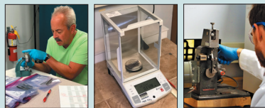
Fig. 3. (a) Thickness tester, (b) Microbalance, (c) MIT Folding Endurance tester
